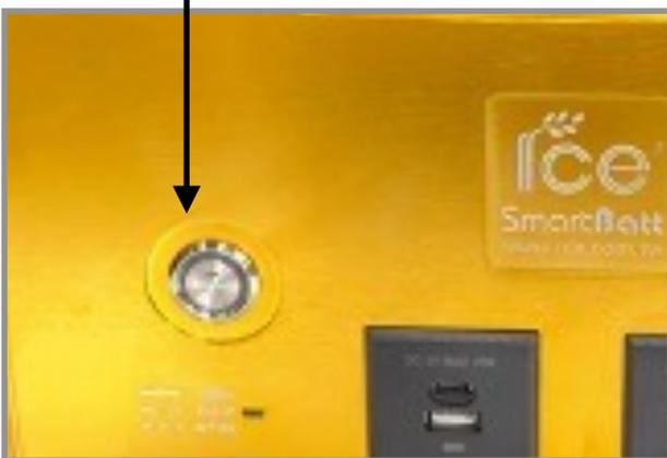
圖8 按下啟動按鈕，無市電也可直接用電池啟動
