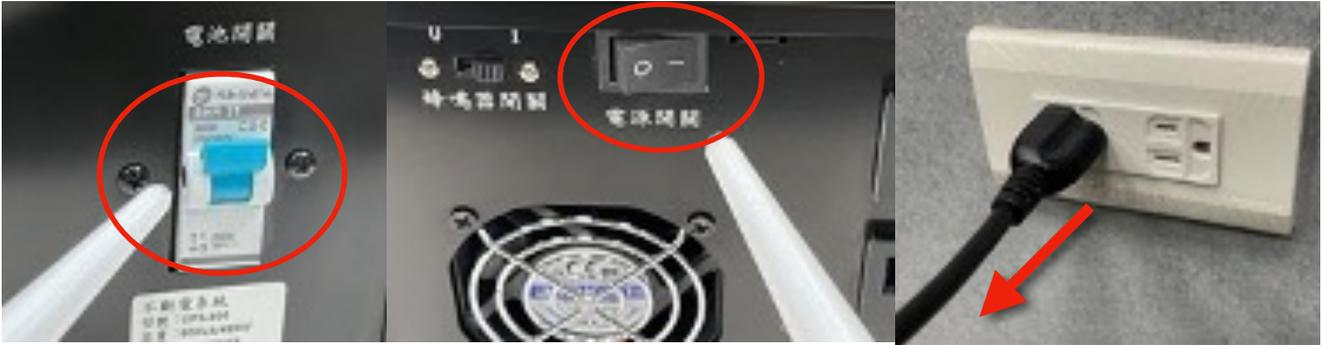
\*如果此時前面板之指示燈 (LED) 會閃爍，蜂鳴器約 3 秒鳴叫一次，表示已切換到備用電力(電池)輸出插座能正常供電，請將市電插頭插回牆壁上之插座。
