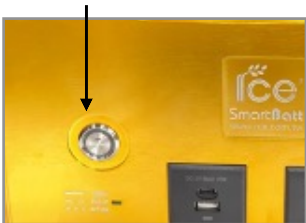
圖8 按下啟動按鈕，無市電也可直接用電池啟動
