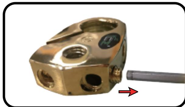
步驟2：使用工具將汽車Micro box專用轉接座的樁頭一邊小螺絲鬆開。
